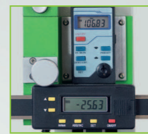
Цифровые дисплеи для отображения значений по осям
